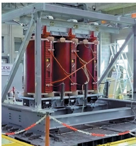
Испытания на сейсмостойкость и виброустойчивость
