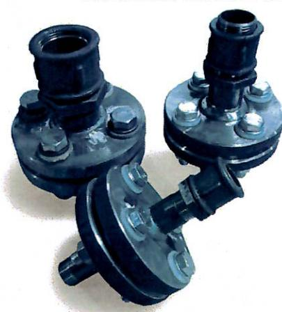
Изолирующее фланцевое соединение (ИФС) предназначено для соединения участков трубопровода с запорной и регулирующей арматурой, защиты трубопроводов от электрохимической коррозии, буждающих и иных видов токов, возникающих при соединении участков трубопровода из различных металлов.
