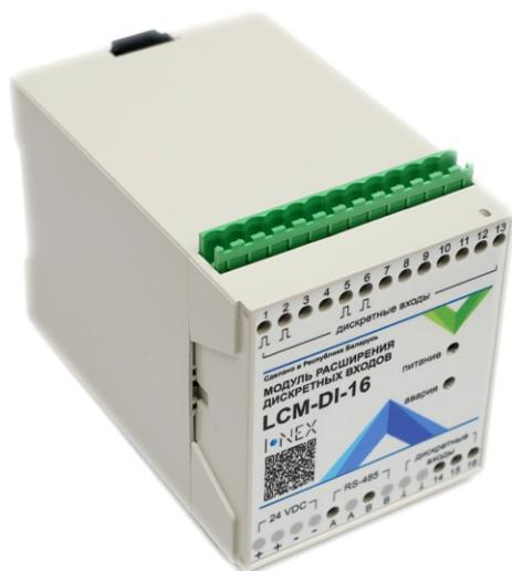
LCM-DI-16 – модуль расширения дискретных входов опрашиваемого мастер-контроллером по протоколу Modbus RTU.
