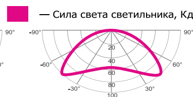
Л (полуширокая) Применяется для светильников серии «Модуль»
