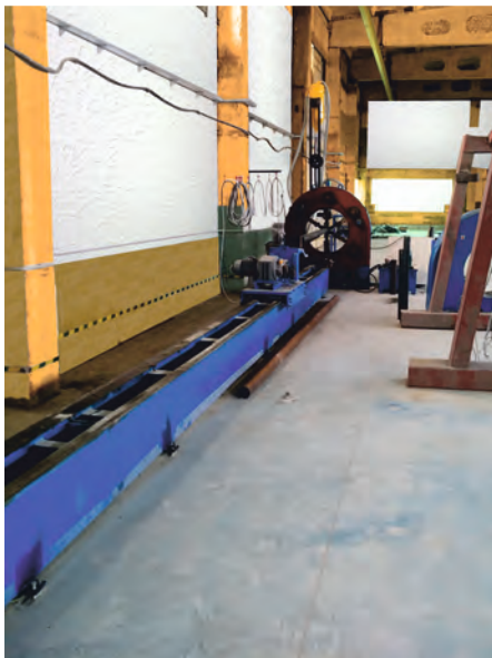
Продольная сварка 12 м
