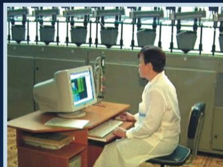
Поверка счетчиков на колокольной установке
