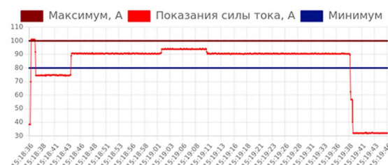
Показания сварочного тока по слою №1, А
