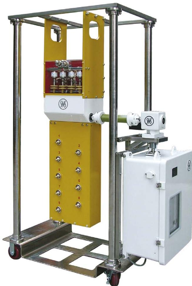
**CZ – устройства РПН с отдельным контактором и переключателем ответвлений, с воздушной изоляцией и разрывом дуги в вакууме.**
