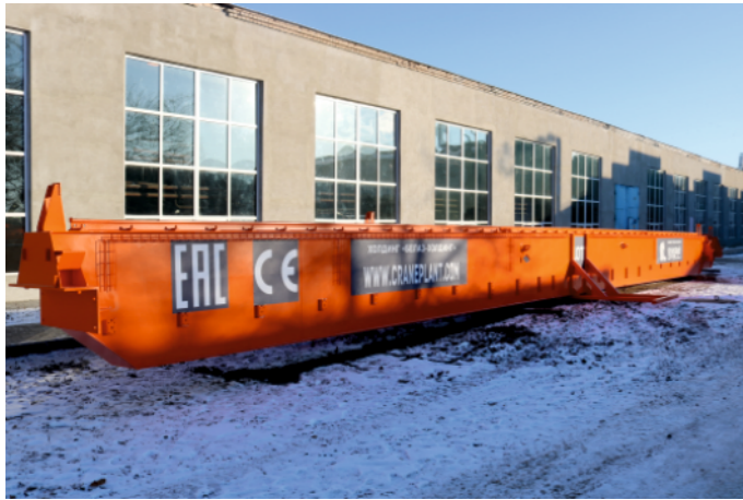
Балка пролетная крана мостового опорного двухбалочного г/п 10 тонн
