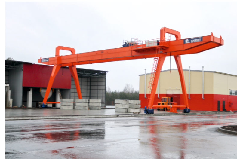
Кран козловой г/п 20 тонн, управлением с пола
