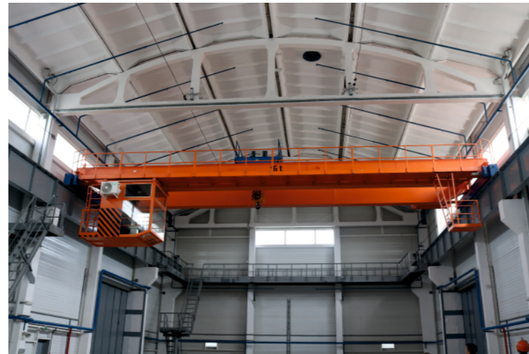
Кран мостовой опорный двухбалочный г/п 16 тонн
